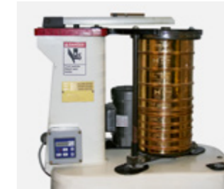
Analyse af ensilage med Ro-Tap Shaker fra Dairyland Laboratories, Inc.
